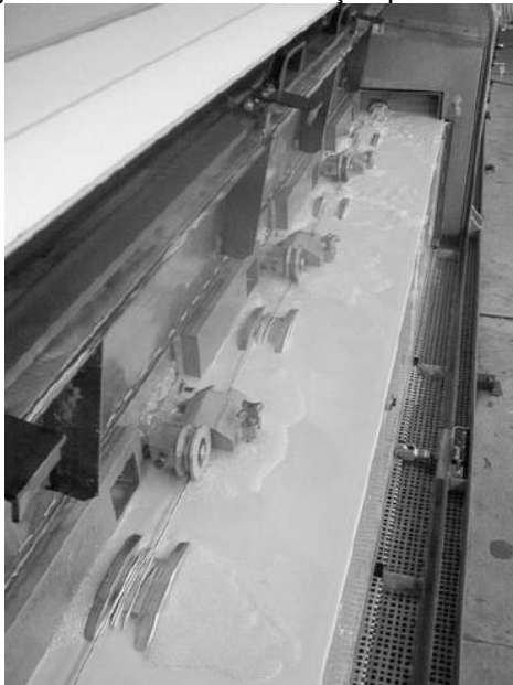
Figura 8. Processo de trefilação por via úmida
