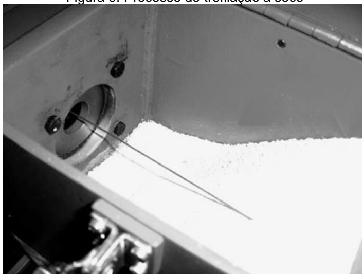
Figura 9. Processo de trefilação a seco
