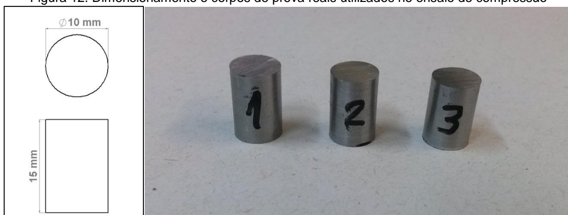
Figura 12. Dimensionamento e corpos de prova reais utilizados no ensaio de compressão
