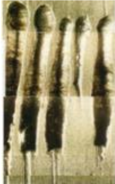
Figura 3.15 Porosidade interna em corte transversal de tarugo, detalhe dos poros sob lupa estereoscópica 6X.
