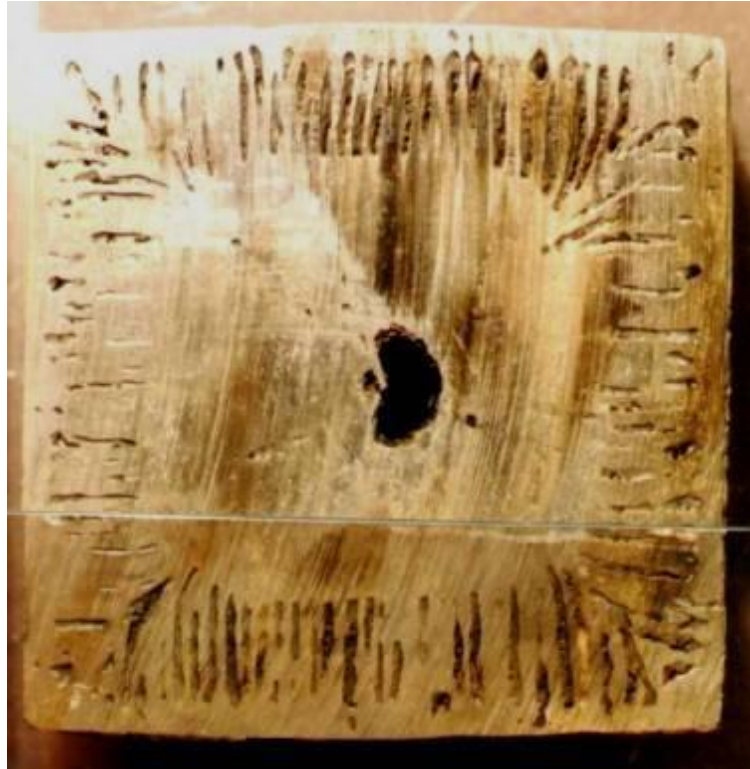
Figura 3.10 Seção de um tarugo apresentando porosidade interna – Fonte: Gerdau 2007.
