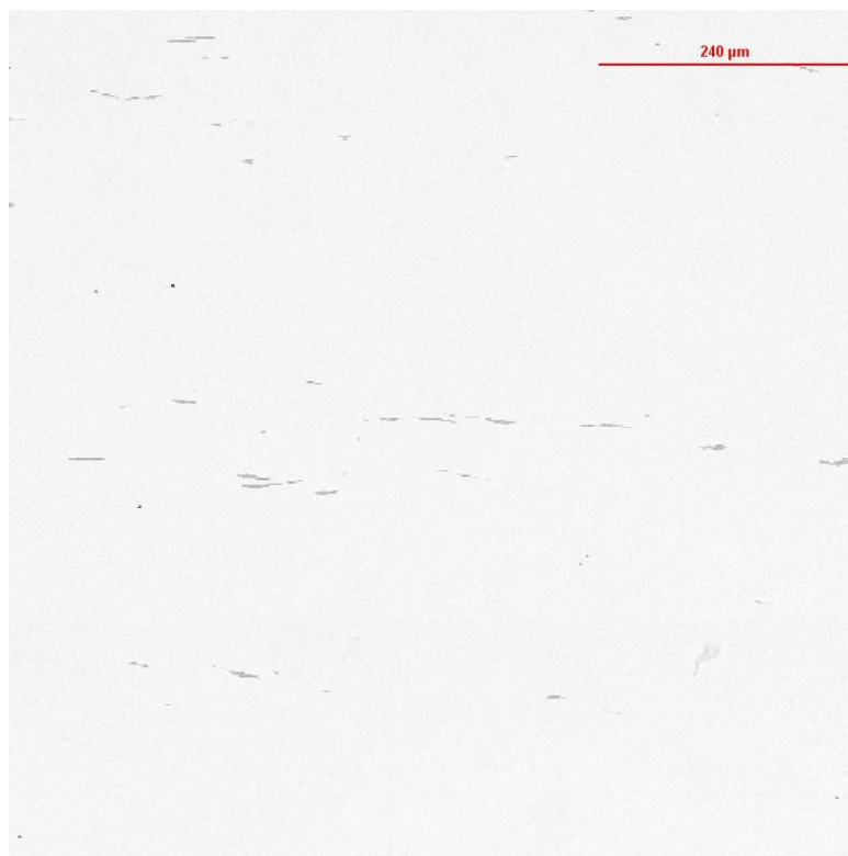
Figura 40: Distribuição das inclusões da amostra L1 em um aumento de 250x (PRÓPRIO AUTOR, 2016).
