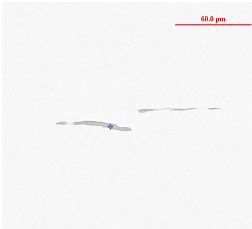
Figura 65: Marcação em azul da inclusão de sulfeto da amostra L9 para análise de EDS em um aumento de 1000x (PRÓPRIO AUTOR, 2016).
