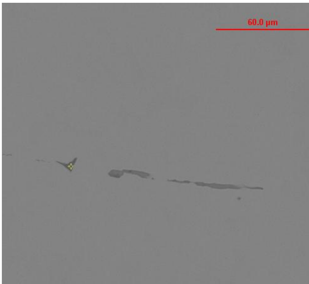
Figura 23: Marcação em amarelo do precipitado de titânio da amostra F1-C (cabeça do lingote) para análise de EDS em um aumento de 1000x (PRÓPRIO AUTOR, 2016).
