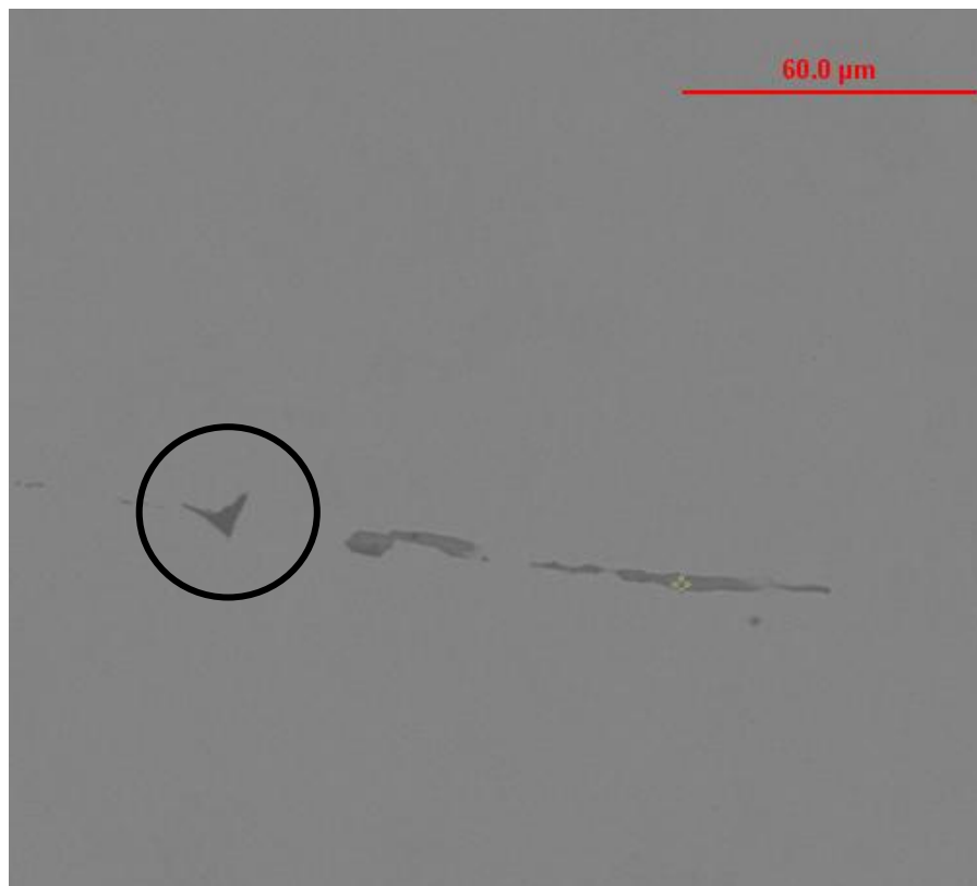
Figura 59: Marcação em amarelo da inclusão de sulfeto da amostra F1-C (cabeça do lingote) para análise de EDS e marcação com círculo do precipitado de titânio em um aumento de 1000x (PRÓPRIO AUTOR, 2016).
