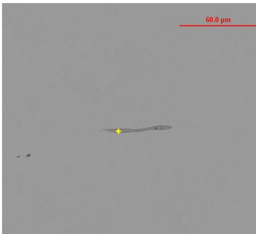
Figura 57: Marcação em amarelo da inclusão de sulfeto da amostra F1-M (meio do lingote) para análise de EDS em um aumento de 1000x (PRÓPRIO AUTOR, 2016).
