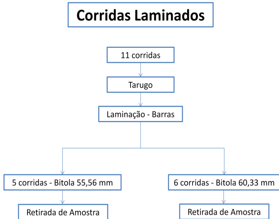
Figura 47: Seleção de amostras de aço laminado (PRÓPRIO AUTOR, 2016).
