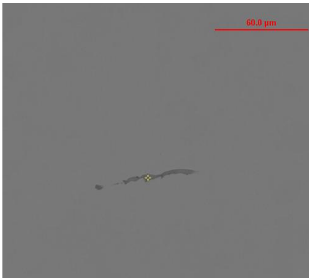
Figura 61: Marcação em amarelo da inclusão de sulfeto da amostra F1-P (pé do lingote) para análise de EDS em um aumento de 1000x (PRÓPRIO AUTOR, 2016).
