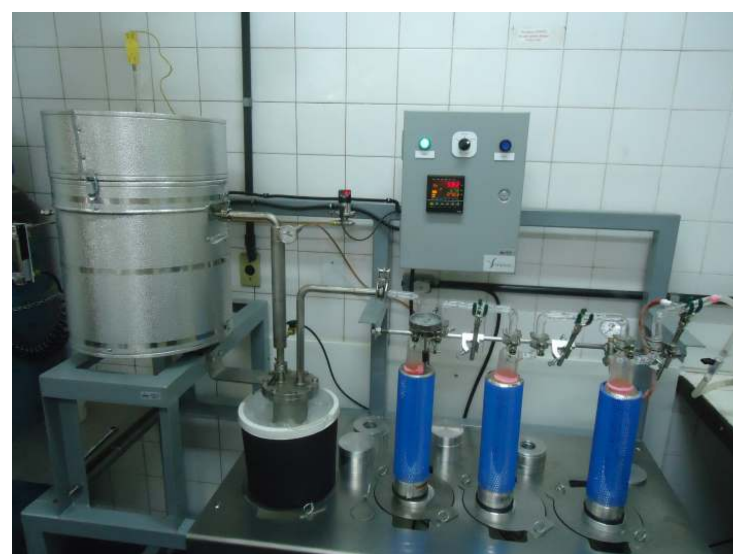
Figura 2. Reator em escala de bancada com capacidade de 400g de amostra.
