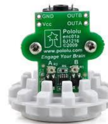
Figura 4: Encoder de Quadratura e Disco
