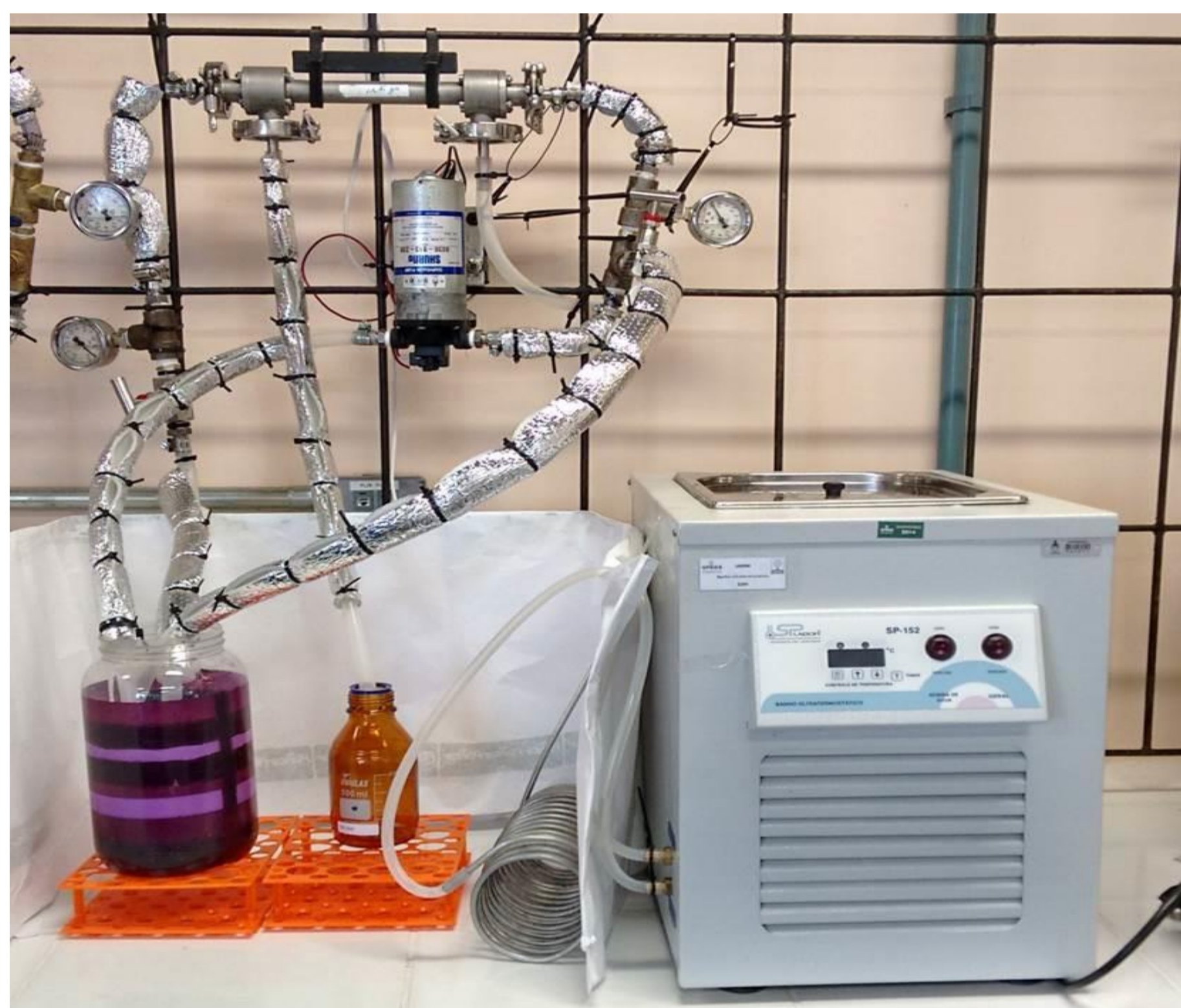
Figura 1 – Sistema de clarificação por membranas.
