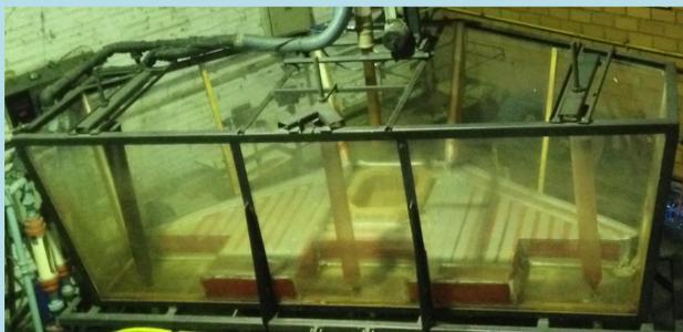
Figura 1 – Modelo físico do distribuidor de lingotamento contínuo localizado no LaSid
