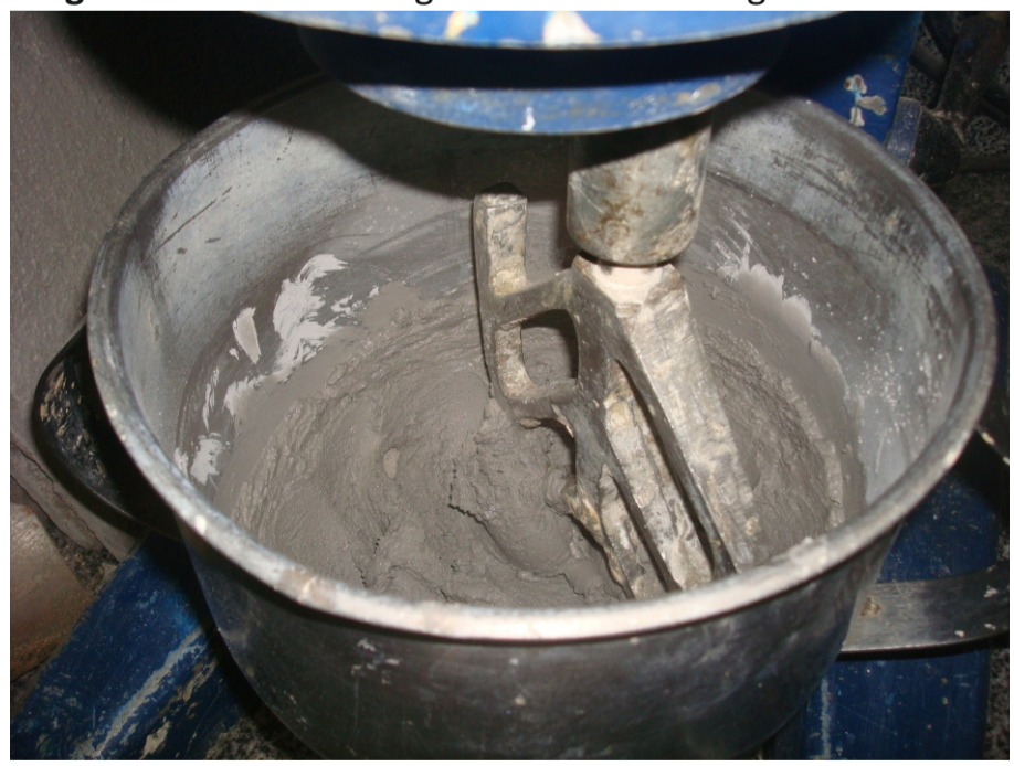
Figura 7: Mistura da argamassa em uma argamassadeira.
