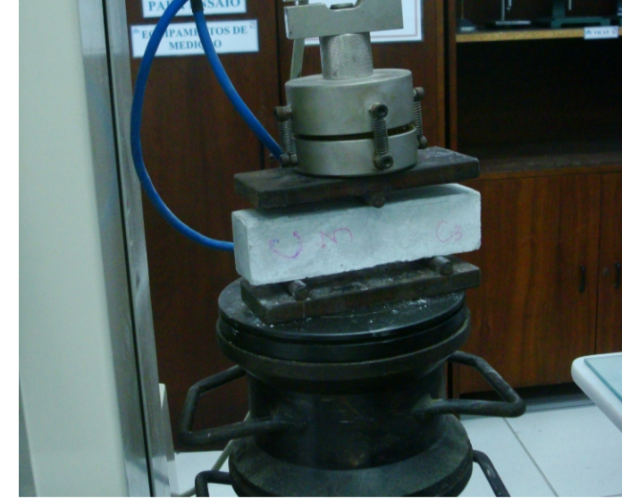
Figura 12: Ensaio de tração na flexão
