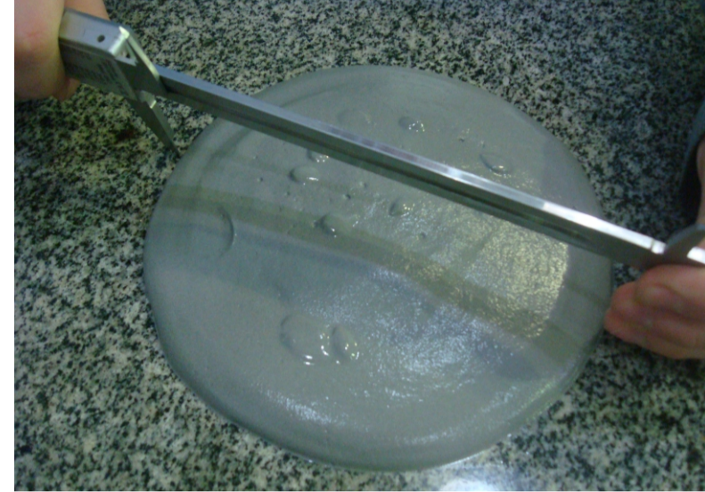
Figura 9: Medição do espalhamento através de um paquímetro.
