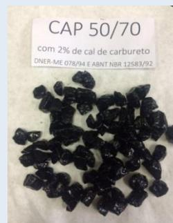
No ensaio de DUI, a razão entre as resistências à tração por compressão diametral dos CPs condicionados e dos CPs não-condicionados indicará a resistência à tração retida por umidade induzida (RRT). Para que a adesividade em análise seja satisfatória, a RRT deve ser maior que 70%, ou seja, a perda de resistência por umidade induzida deve ser inferior a 30%. O gráfico abaixo mostra os valores de RT de cada grupo e a perda de cada mistura:
