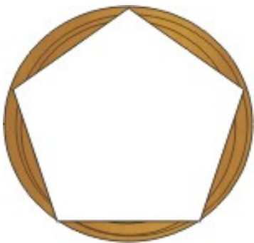
Figura 45 - Área de costaneiras.
