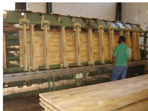
Figura 21- Painéis colados de grandes dimensões
