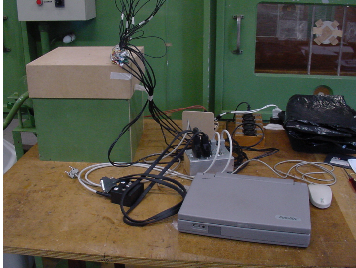
Figura 25: Equipamento utilizado para calibração dos sensores de temperatura
