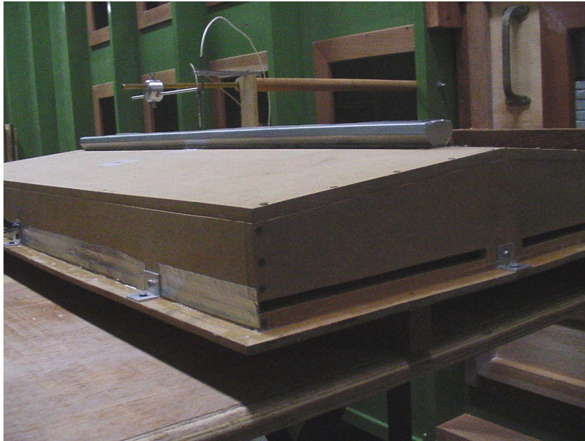
Figura 33: Detalhe do fechamento de algumas aberturas de entrada no modelo, com fita adesiva de alumínio
