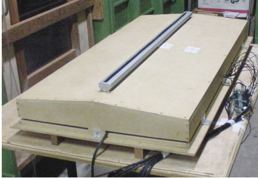
Figura 14: Modelo do pavilhão industrial em escala 1/100, com as aberturas de entrada e saída do ar
