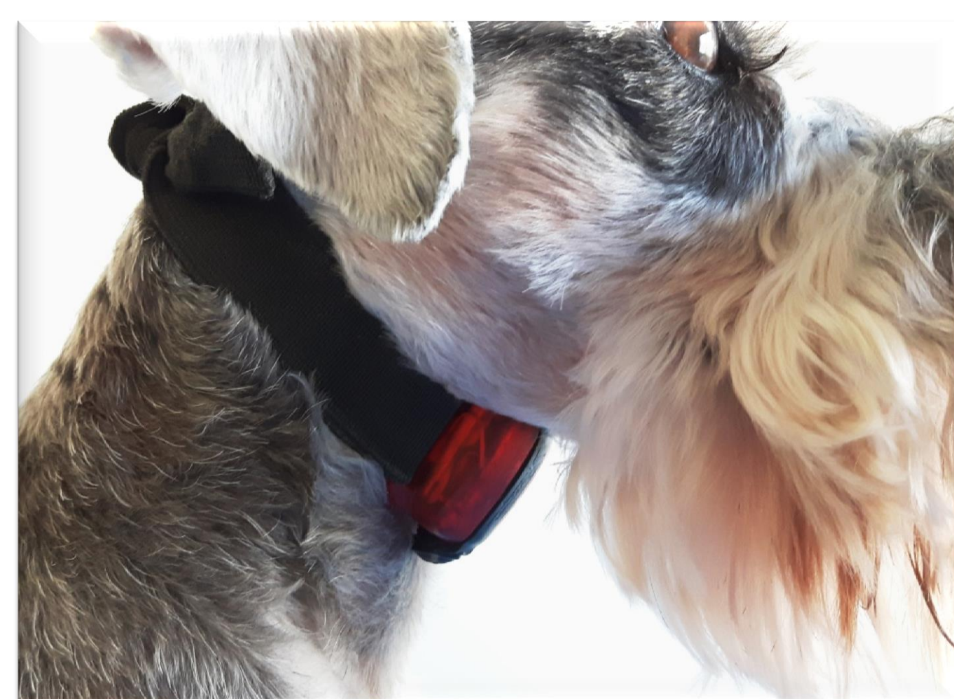
Figura 2 - Acelerômetro posicionado ventralmente no pescoço do cão com uma coleira elástica.
