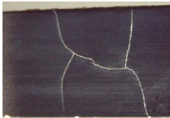
Figura 1: Trinca na peça tratada com salmoura aquecida por 6,5 s
