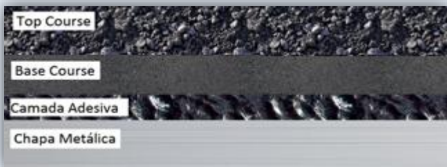
Figura 3 – Estrutura do Pavimento
