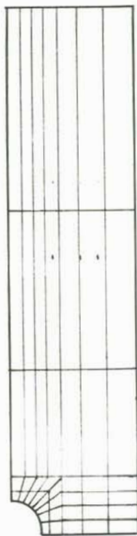
Figura 8.8 - Malha de elementos finitos
