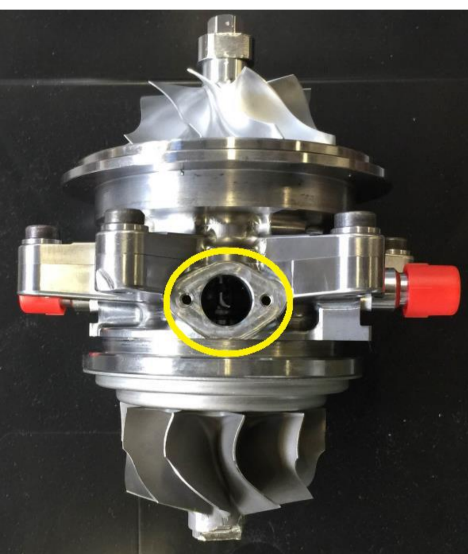
Figura 1: Turbocompressor modificado. O círculo amarelo indica onde está a turbina Pelton
