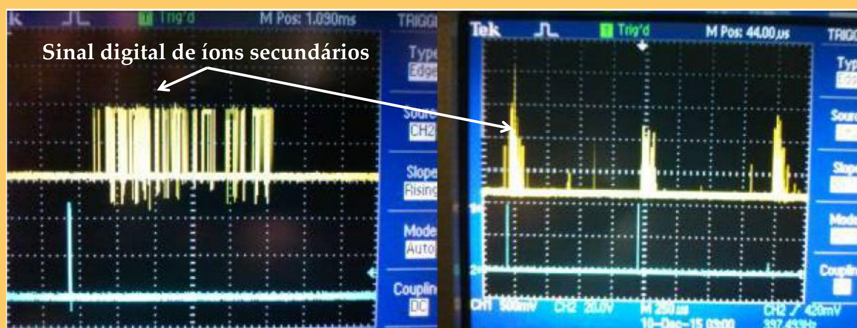
Fig.4 Fotografia da esquerda: pulso digitalizado (sinal de saída ECL do discriminador) após eliminação do ruído. Em azul se observa o pulso TTL utilizado para marcar a seqüência de disparos. Fotografia da direita: Seqüência de três pulsos digitais captados no osciloscópio e o correspondente aos pulsos TTL. Frequência de pulso 1 kHz.
