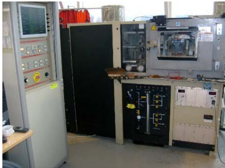
Figura 3.4: Simulador termo-mecânico Gleeble 1500 D utilizado para a simulação dos ciclos térmicos de recozimento.
