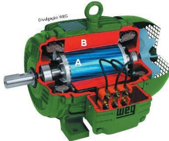
Figura 2.5: Aços elétricos presentes nos componentes A rotor e B estator de um motor elétrico. Adaptada de Buys (2006).
