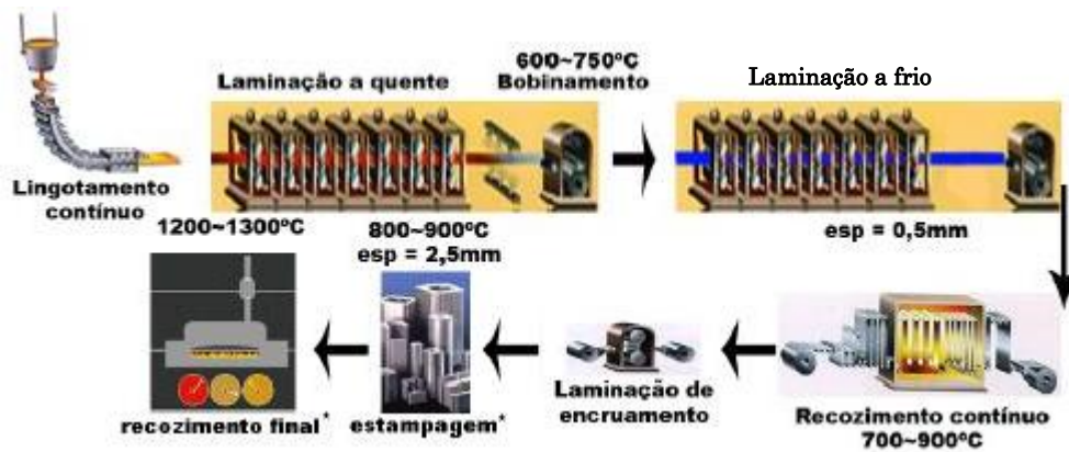
Figura 2.17: Esquema do processo de fabricação dos aços elétricos GNO semiprocessados. Retirada de Castro (2008).
