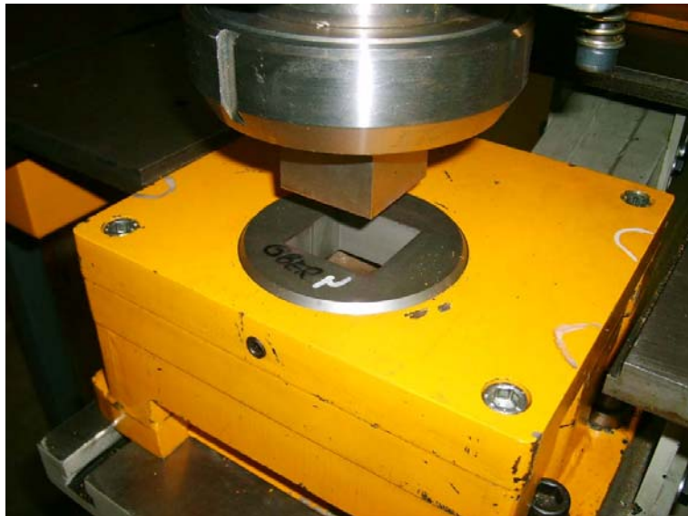
Figura 4.2: Ilustração do punção danificado utilizado para puncionar as amostras dos grupos A, B, C e D.
