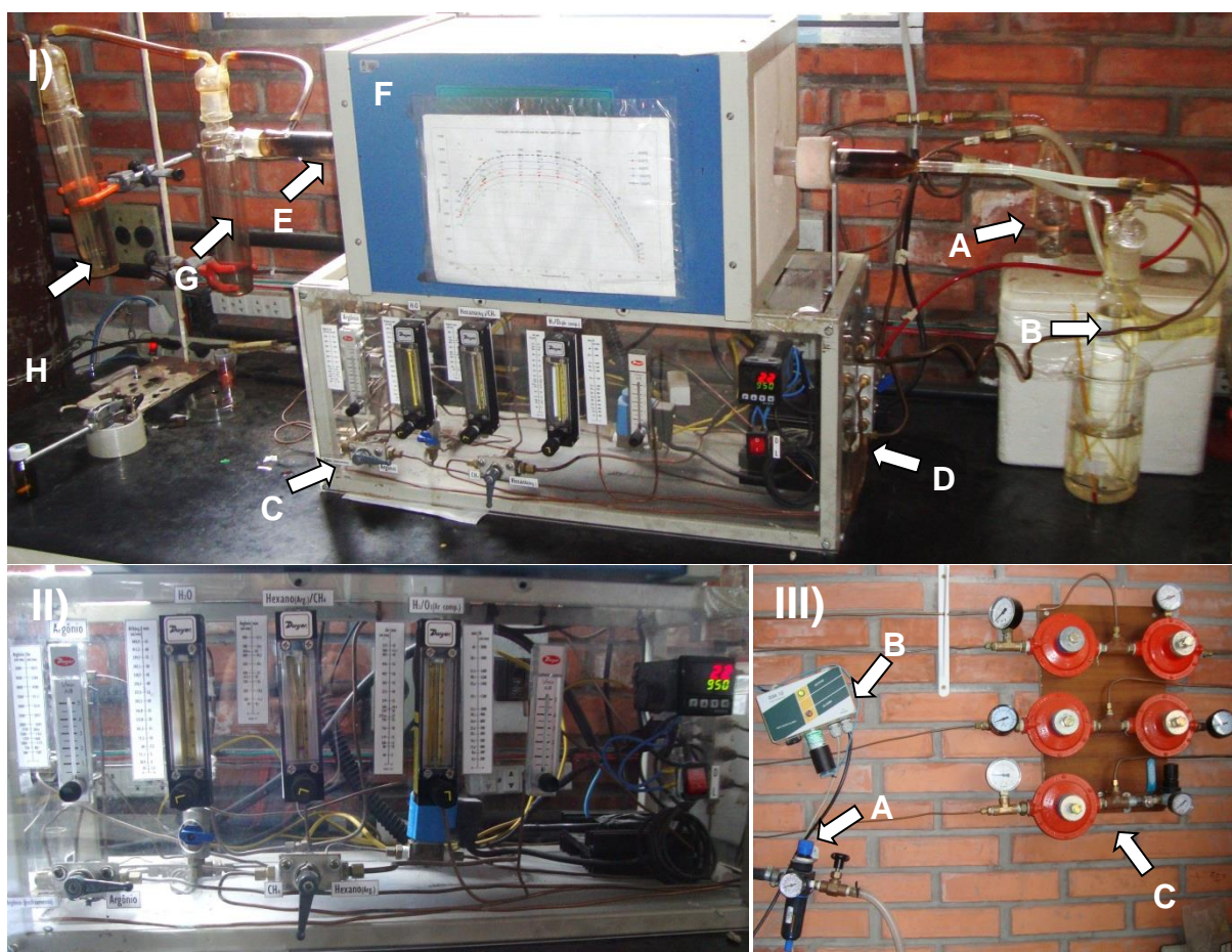
Figura 5.4 – I) Reator de CVD de leito horizontal sendo: A) Borbulhador com precursor de carbono; B) Borbulhador de H_2O ; C) Controladores de fluxo; D) Misturador na entrada de gases; E) Tubo de quartzo; F) Forno elétrico; G) Borbulhador “Trap”; H) Borbulhador com H_2O para a saída de gases; II) Controladores manuais de fluxo. III) A) regulador de pressão da linha de ar comprimido; B) sensor de gases combustíveis e; C) central estabilizadora de pressão.
