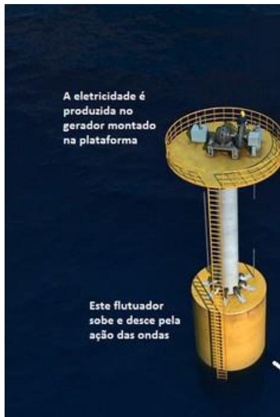
Figura 2.13 – Funcionamento do dispositivo. (Planeta COPPE, 2015)
