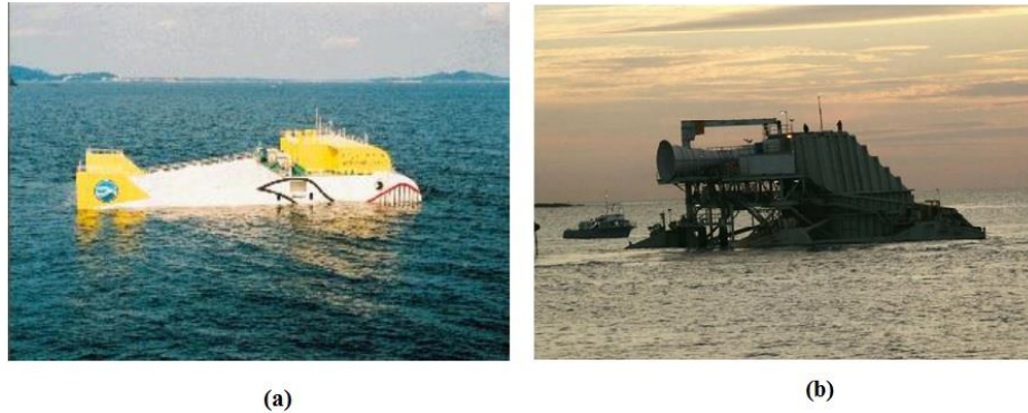
Figura 2.7 – Projeto de dispositivo: CAO Mighty Whale, Japão (a); CAO Energetech, Austrália(b). (Barreiro e Gil, 2008)
