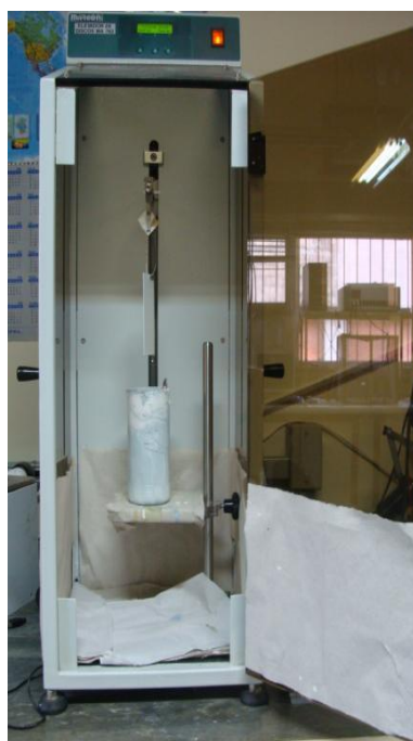
Figura 21 - Equipamento Deep Coating Elevador de Disco MA 765-Marconi utilizado para imersão de peças de aço AISI 1010, em TI e TCA, TCE e TCP.
