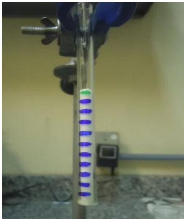
Figura 7: Tubo marcado com espaçamento de 5 mm, contendo amostra de sacarose
