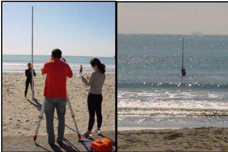
Figura 26 - Fotos que ilustram o desenvolvimento do levantamento do perfil praiial (fotos: Glaucio Vintem).
