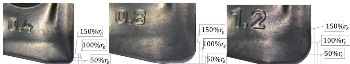
Figura 7.7 – Pastilhas utilizadas mostrando os raios de ponta.
