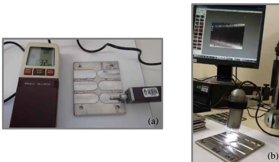
Figura 7.6 – Sistemas de medição: (a) aquisição de dados de rugosidade; (b) aquisição de imagens do perfil de rugosidade.
