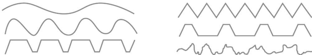
Figura 4.7 – Diferentes perfis de rugosidade com mesmo valor de “ R_a ”.
