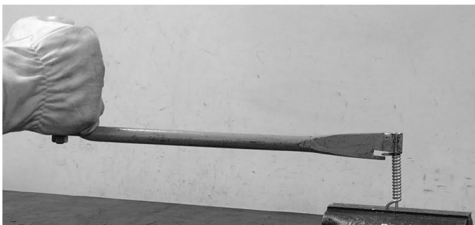
Figura 43 Dispositivo para realização dos ensaios de enrolamento dos arames Fonte: CORTESIA DE USINA SIDERÚRGICA.
