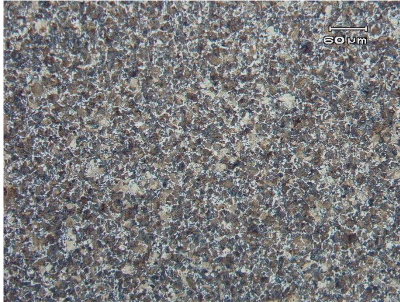
Figura 48 Microestrutura da seção transversal de uma amostra de fio-máquina do aço AOX, revelada a partir de ataque Nital 2% e com aumento de 200X
