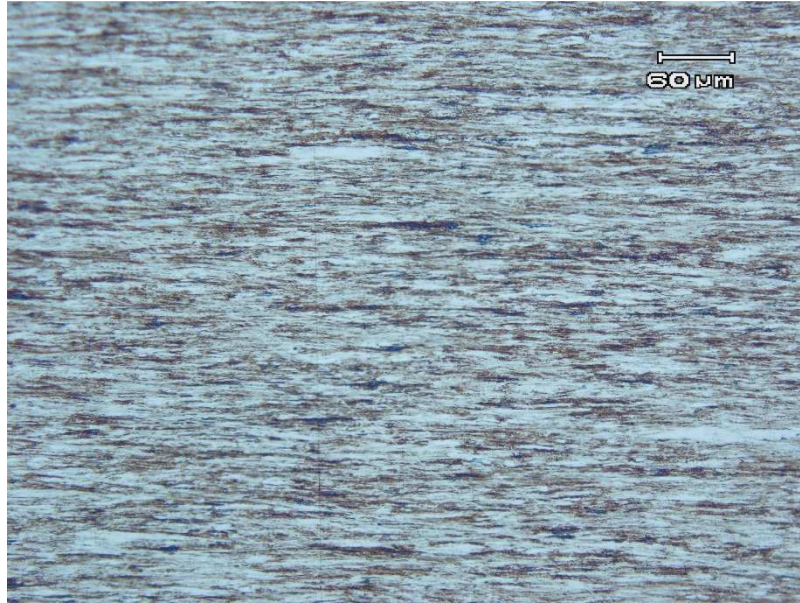
Figura 45 Microestrutura da seção longitudinal de uma amostra de arame da condição AEL 1, revelada a partir de ataque Nital 2% e com aumento de 200X
