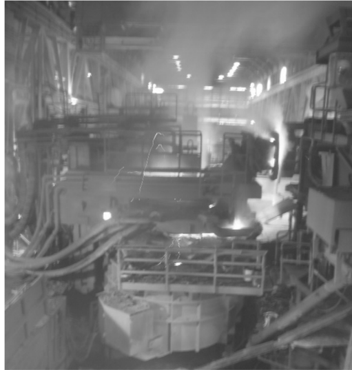
Figura 11 Forno elétrico a arco utilizado para a fusão da carga metálica na produção de aço. Fonte: CORTESIA DE USINA SIDERÚRGICA
