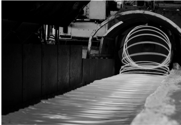
Figura 16 Equipamento situado ao final do processo de laminação responsável pela formação das espiras. Fonte: Adaptado de WIREFIRST.COM, 2011
