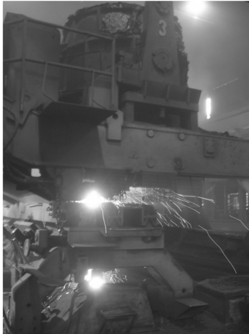
Figura 13 Panela repassando o aço líquido para o distribuidor, que por sua vez, repassa aos veios da máquina de lingotamento contínuo.
