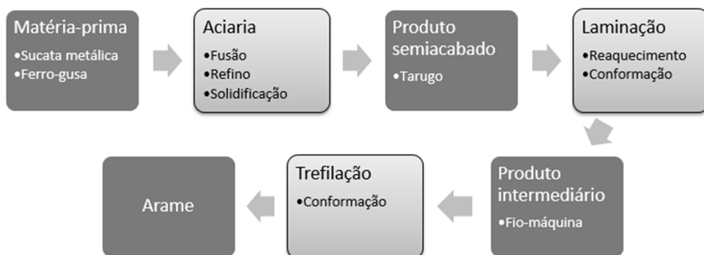
Figura 9 Fluxo esquemático da rota de produção de arames de aço em uma usina siderúrgica.
