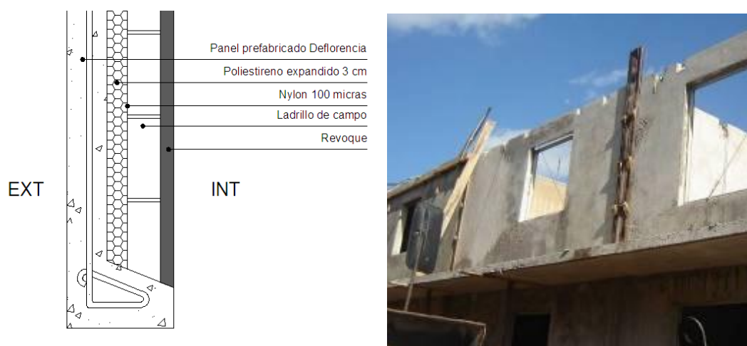
Figura 30: Características técnicas de muros exteriores
