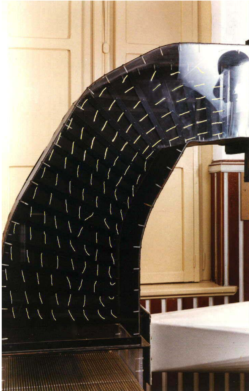
Fig. 4.1 : Visualização do escoamento, na configuração inicial ( Re = 8,9 \cdot 10^4 ).
