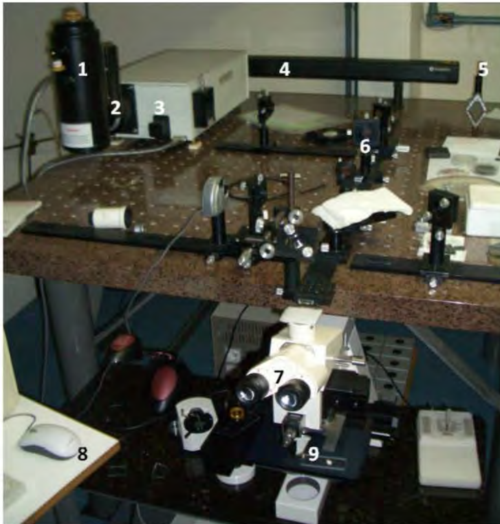
Figura 33: Disposição do espectrômetro micro-Raman no Laboratório de Microanálise do IF-UFRGS: 1- reservatório com nitrogênio líquido, 2 - câmara CCD, 3 - espectrômetro para dispersão da luz, 4 - laser de He-Ne, 5 - atenuador (polarizador), 6 - filtro notch , 7 - microscópio óptico, 8 - computador com software de controle, 9 - plataforma (platina de movimentação micrométrica) da amostra.
