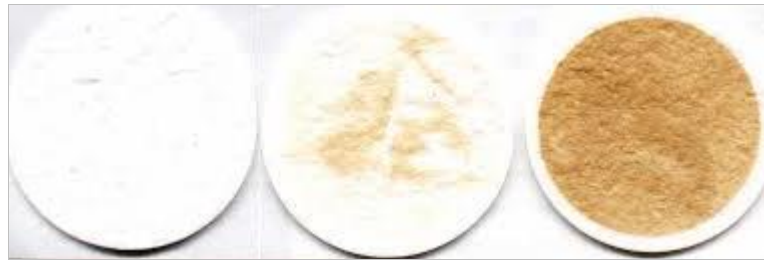
Figura 6 – Filtro Cambridge , antes e depois da coleta do material particulado da fumaça de cigarros, durante o ensaio em máquina de fumar
