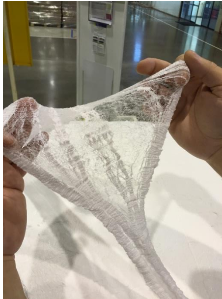
Figura 13 – A estrutura da banda de monofilamentos do cabo de acetato
