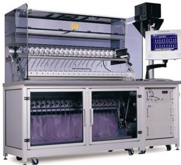
Figura 16 – Máquina de fumar modelo SM 450, utilizada para a coleta da fase particulada e fase vapor da fumaça principal de cigarros
