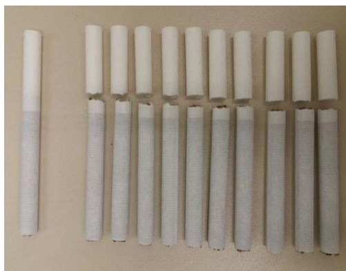
Figura 17 – Preparo dos filtros de cigarro para o ensaio de queda de pressão
