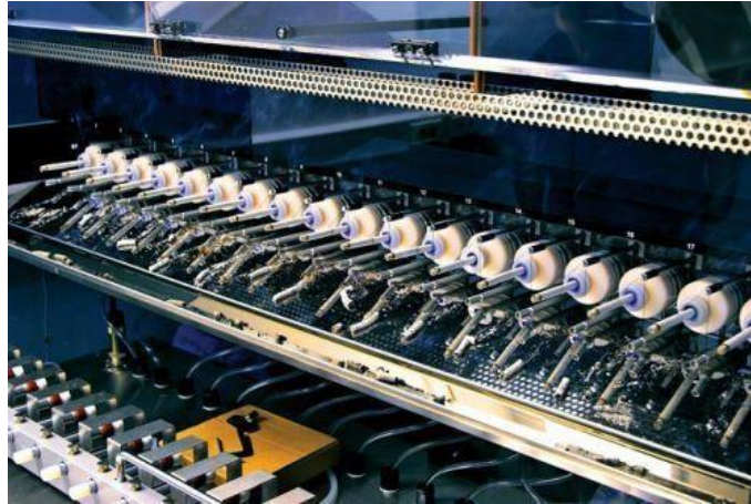
Figura 18 – Suporte contendo o filtro Cambridge durante o ensaio de fumada de cigarros em máquina de fumar
