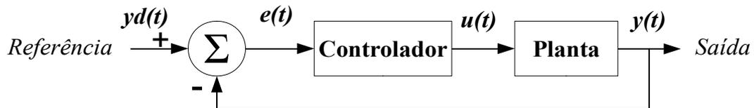
Figura 3.14 – Controle para cada módulo mecatrônico
