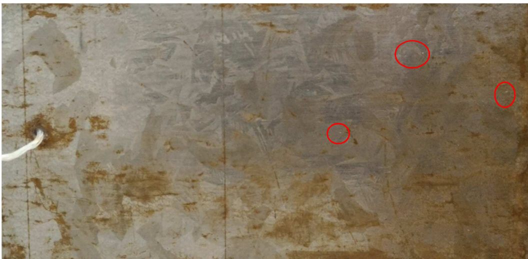
Figura 30 – Peça de aço galvanizado com revestimento de tanino (A_60) após exposição de 2 meses.
