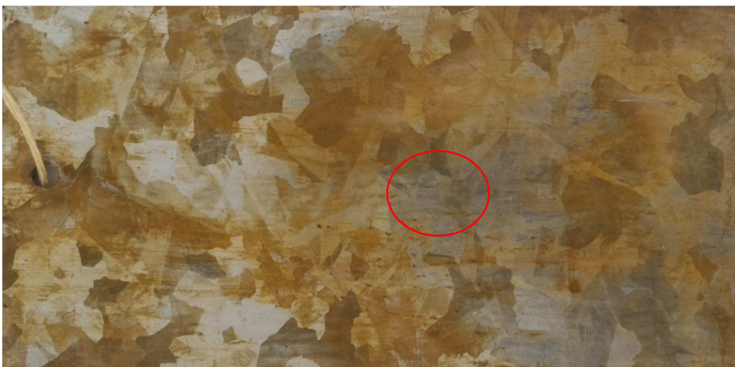
Figura 32 – Peça de aço galvanizado com revestimento de tanino (C_30) após exposição de 2 meses.
