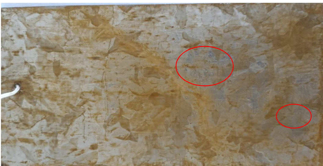
Figura 29 – Peça de aço galvanizado com revestimento de tanino (A_30) após exposição de 2 meses.
