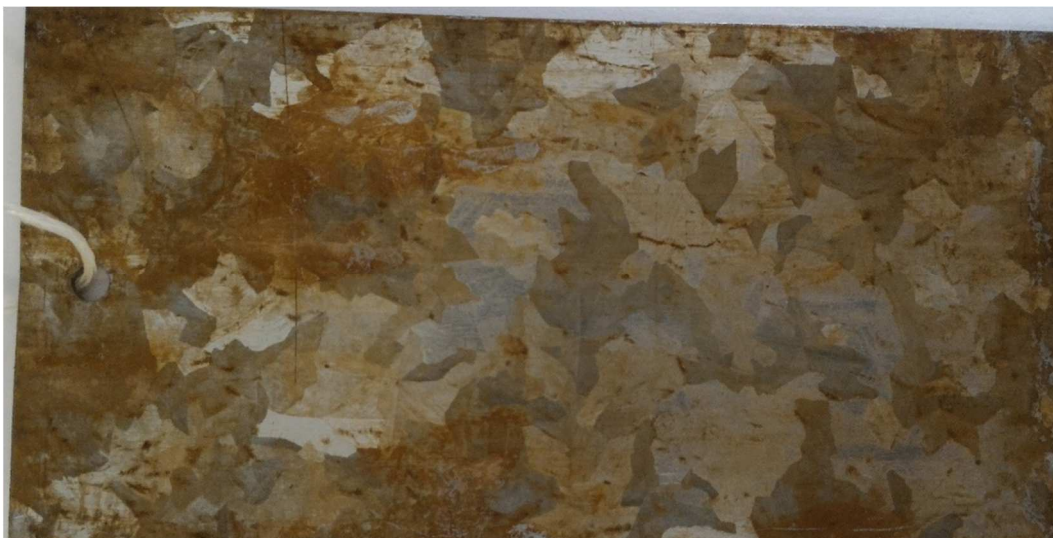
Figura 33 – Peça de aço galvanizado com revestimento de tanino (C_60) após exposição de 2 meses.
