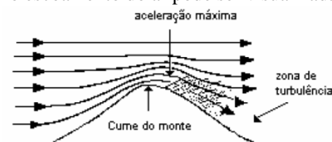
Figura 4.8. Influência de relevo acentuado nas linhas de corrente do vento (Caldas, 2010).
