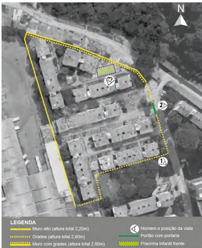
Figura 4.2: Cercamento do conjunto Oásis
