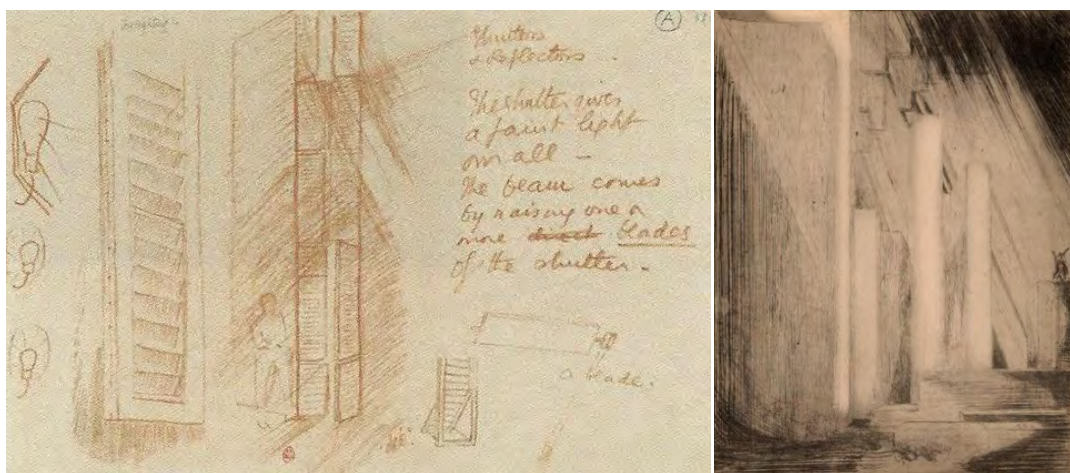
Figura 129. Sistema para iluminación de Craig, con persianas y reflectores. Fuentes: CASTAÑO, 2009:285.
