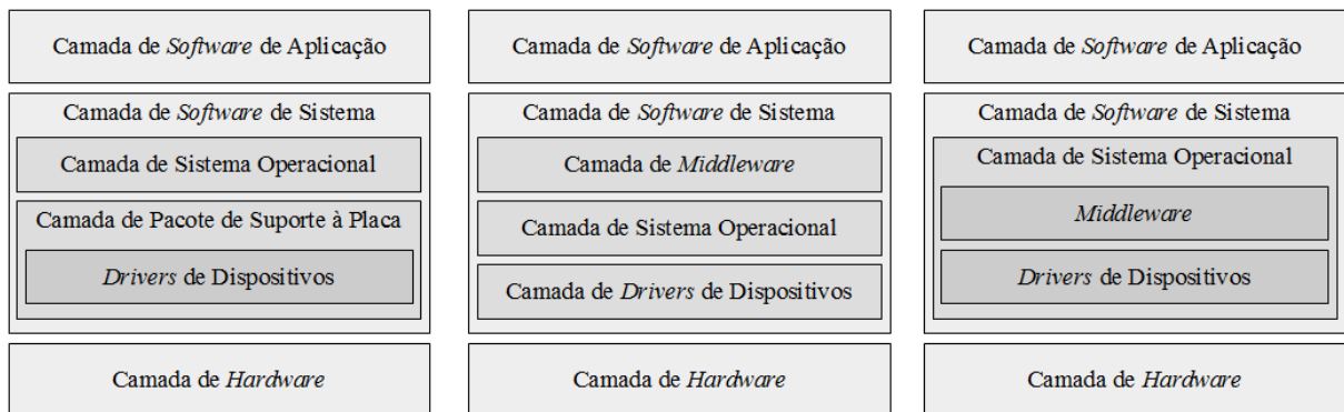
Figura 2.6 – Camada de Software de Sistema – SO
