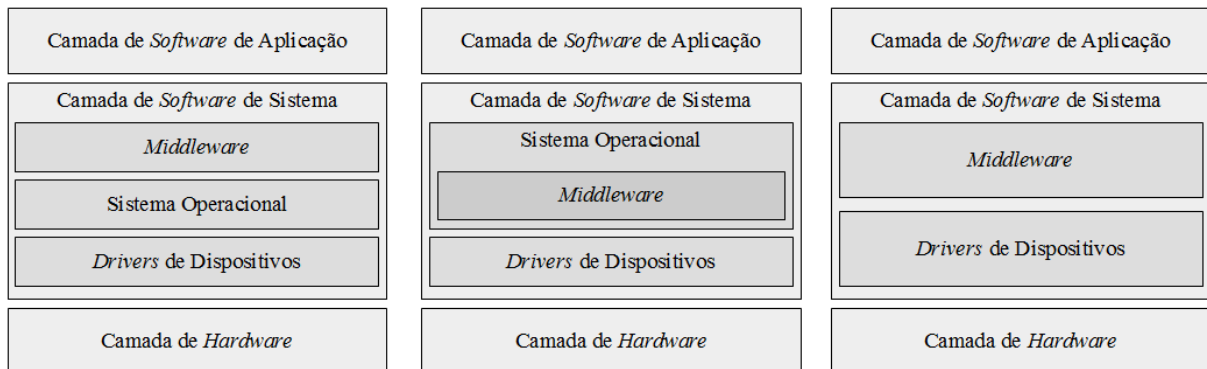
Figura 2.7 – Camada de Software de Sistema – Middleware
