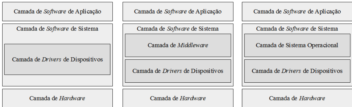
Figura 2.5 – Camada de Software de Sistema - Drivers
