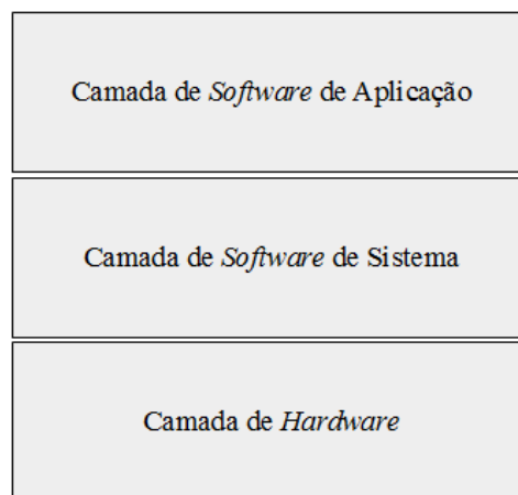
Figura 2.1 – Modelo de Sistemas Embarcados
