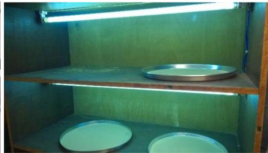
Fig 12: Esterilização de ovos de anagasta a base de raio ultravioleta UV.
