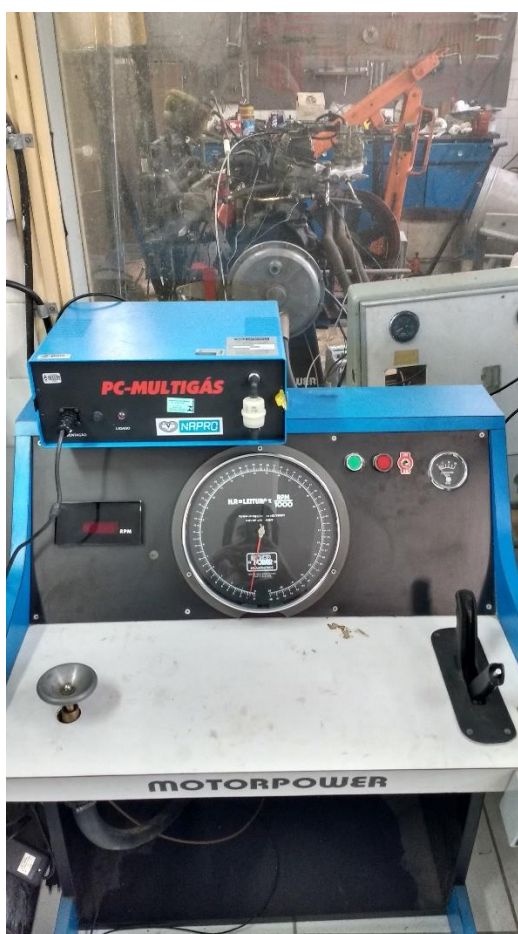
Figura II: Fotografia da sala de controle mostrando o equipamento de controle do dinamômetro e ao fundo a sala de testes onde pode-se visualizar o motor e dinamômetro.
