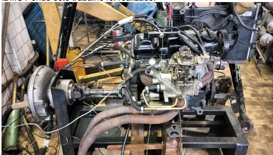
Figura I: Fotografia da instalação do motor e dinamômetro. À esquerda pode-se visualizar o dinamômetro e, à direita, o motor utilizado.
