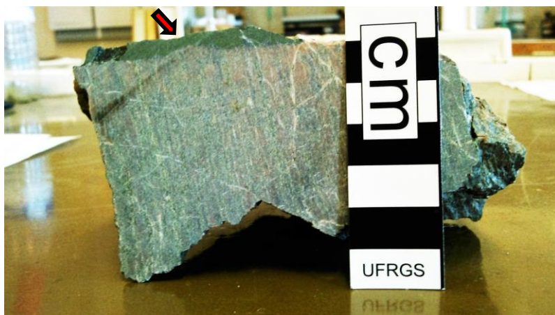
Figura 11: Fotografia da amostra macro de IB 06 mostrando a superfície do corte para laminação. A seta vermelha indica o veio centimétrico de clorita neoformada cortando a foliação principal. É nítida a cloritização de toda a rocha, assim como um bandamento gnáissico bem definido. É possível observar veios e vênulas milimétricas de quartzo e principalmente carbonato, predominantemente transversais ao bandamento.
