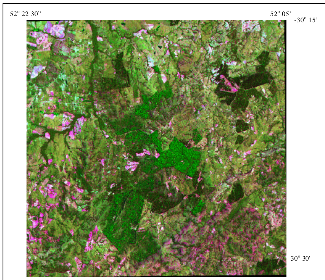
Figura 6.10 - Composição colorida RGB com as imagens razões, 5/3*7, 5/7*3 e 2/4*7. O verde-escuro identifica as áreas reflorestadas; em verde-médio a mata de galeria e mata nativa; e, em tons verde claro a ocorrência de vegetação rala ou campos. Em tons de magenta os solos expostos e afloramentos.
