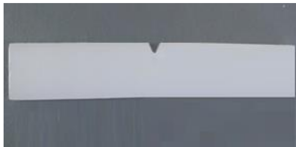
Figura 5 - Corpo-de-prova teste de resistência ao impacto Izod.
