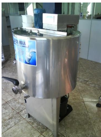
Figura 8: Tanque de pasteurização e maturação (Fornecida pelo fabricante).
