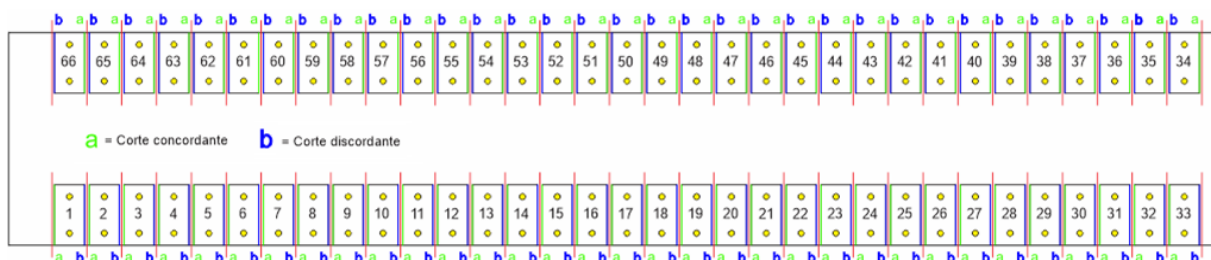
Figura 4.2 – Cortes e furações da chapa de MDF
