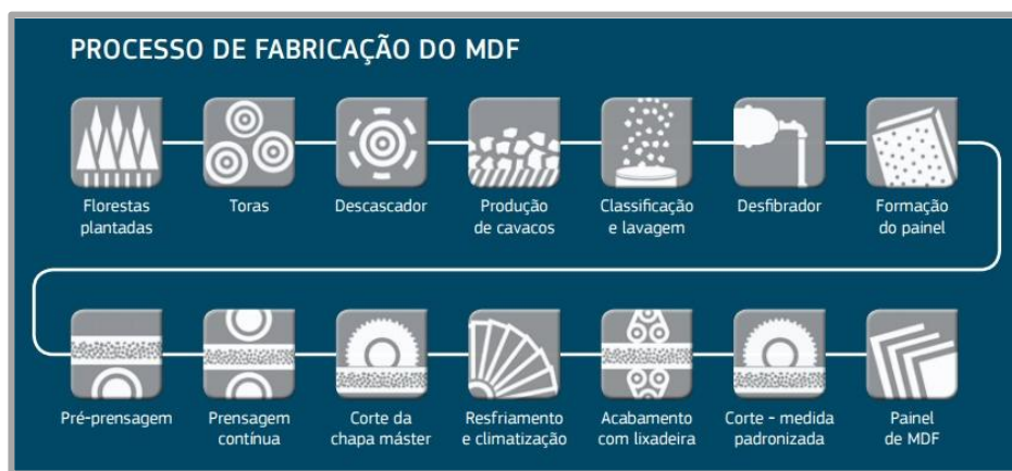
Figura 1.1 – Processo de produção da chapa de MDF [Eucatex, 2015]
