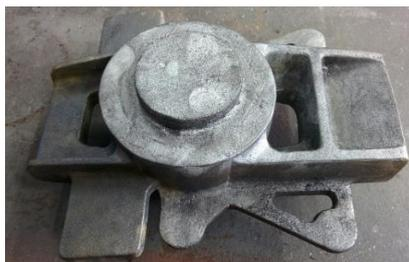
Figura 4.10: Modelo de fundição impresso em plástico PLA, com acabamento de massa plástica e marcação para macho.
