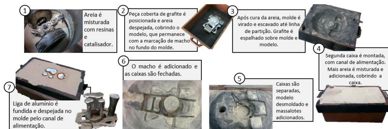
Figura 4.11: Fluxo de processo para fundição em areia curada frio.
