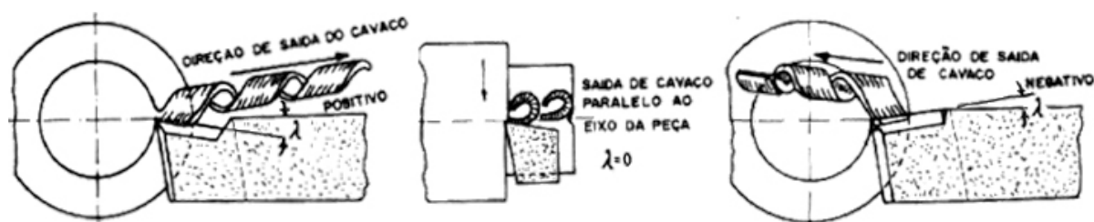
Figura 3.1 – Saída do cavaco segundo o ângulo de inclinação [adaptado de Stemmer, 1993].
