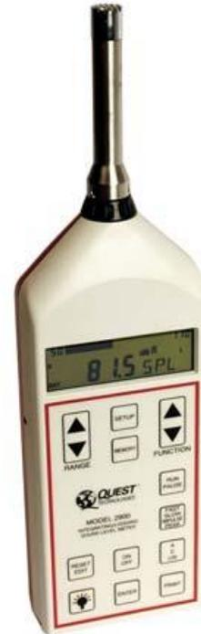
Figura A.1 – Especificações técnicas do decibelímetro Quest Pro 1900 (Type 1).
