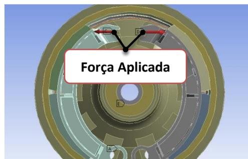
Figura 3.9 Força de acionamento aplicada ao modelo de CEA.
