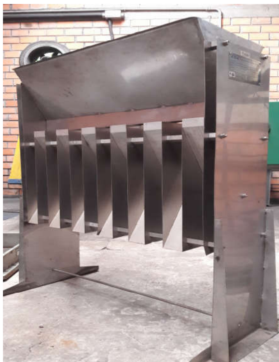
Figura 25: Ilustra o quarteador Jones usado no trabalho
