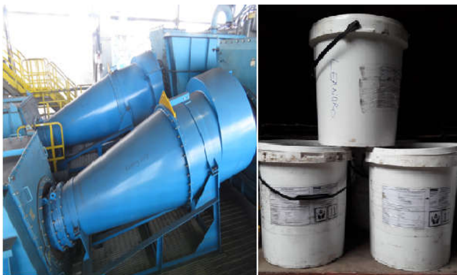
Figura 23: A figura (a esquerda) ilustra ciclones de meio denso de onde foram colhidas as amostras e a figura (a direita) ilustra as amostras recebidas pela mineradora.
