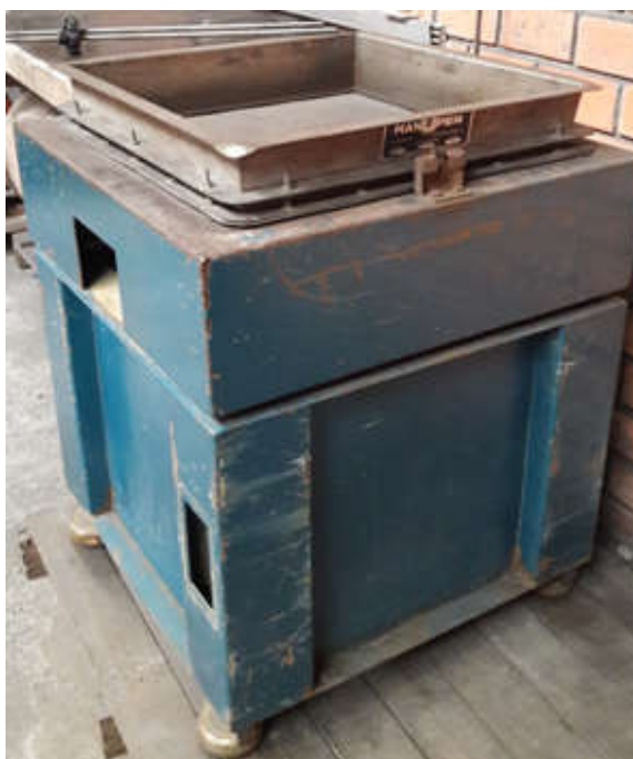
Figura 26: Ilustra peneiras sobre um agitador mecânico
