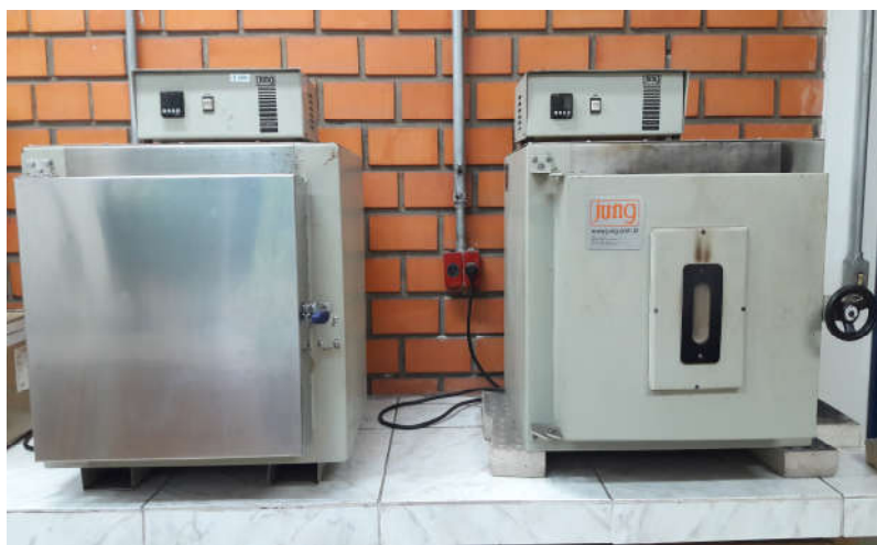
Figura 29: Forno mufla usado para análises de teor de cinzas
