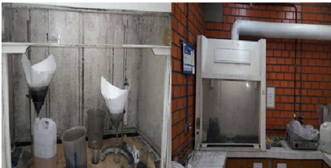
Figura 27: A fig (a esquerda) ilustra o processo de separação por meio denso e a fig (a direita) ilustra o processo de secagem das amostras na capela
