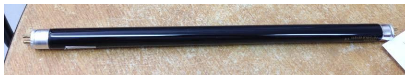
Figura 4: Lâmpada fluorescente de luz negra (ECOLUME) utilizada no foto-reator.
