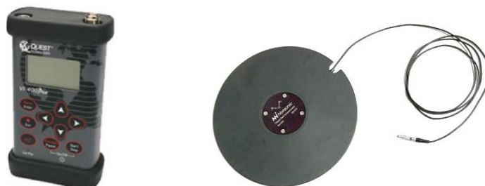
Figura 4.1 – Medidor portátil Quest VI-400 Pro e seatpad utilizados nas medições
