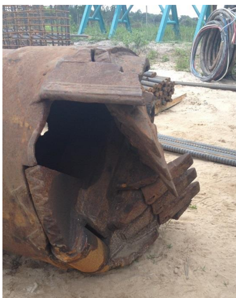
Figura 5. 10 – Caçamba usada na escavação
