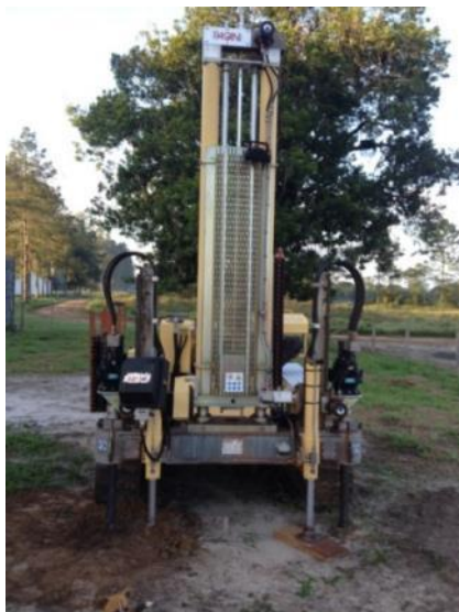
Figura 4. 13 - Equipamento usado para o ensaio CPTu
